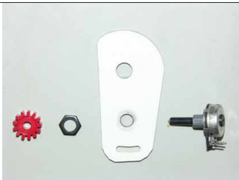
5 : Le support potentiomètre en PVC ép. 3 mm fait également office de réglage fin (ajustage des valeurs entre les 2 potars du même groupe, Gaz, Throttle ou Mixture).
